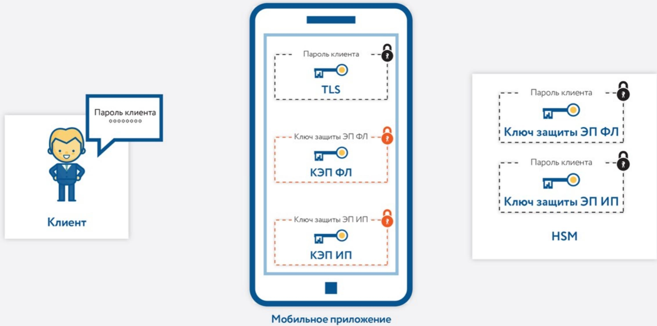
Не допускается хранение ключей ЭП и ключей аутентификации без их предварительного шифрования (которое должно осуществляться встроенной функцией ПКК). При этом должно быть реализовано:
