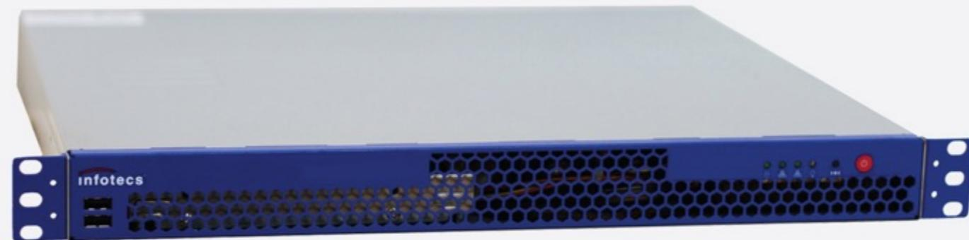
**ViPNet TLS Gateway** – это шлюз безопасности, предназначенный для установления защищенных соединений по протоколу TLS v. 1.2 с использованием российских криптоалгоритмов ГОСТ.
